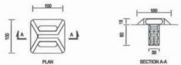
REFLECTORISED PAVEMENT STUD
